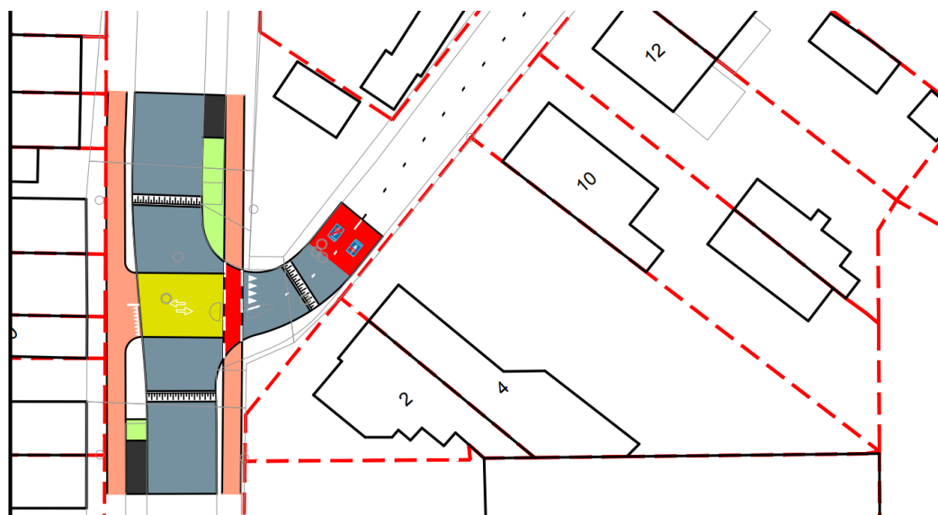
Figuur 14: Inrichtingsplan kruispunt Misstraat x Lijsterstraat ivv fiets snelweg (bron: fietssnelwegen.be)
